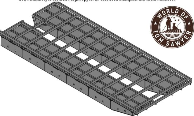
Gesamtauftrieb: 7.620 daN (kg) entsprechend 20 x Schwimmkörper TS\_01 und 4 x TS\_02
