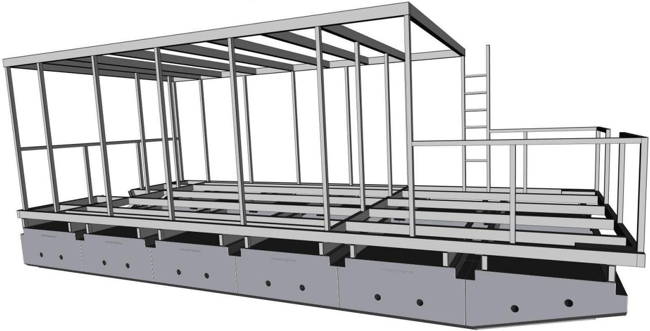
**Gesamtauftrieb: 7.620 daN (kg)** entsprechend 20 x Schwimmkörper TS\_01 und 4 x TS\_02
